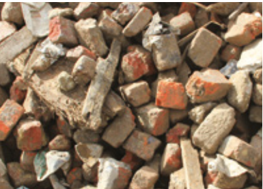
Deponieaushub 2-stufige Trennung: Absieb 90 – 200 mm
