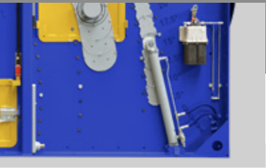
Hydraulische Verstellbarkeit Anpassung des Neigungswinkels der Paddel
