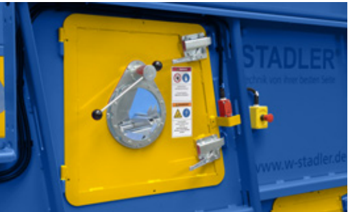
Wartungstüre Einfacher Zugang zum Inneren des Separators für Wartungs- und Reinigungszwecke
