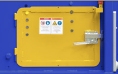
Wartungstüren Einfacher Zugang zum Inneren des Separators für Wartungs- und Reinigungszwecke
