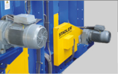
Zwei Antriebe Einzigartige Antriebslösung zur Verlängerung der Wellenlebensdauer
