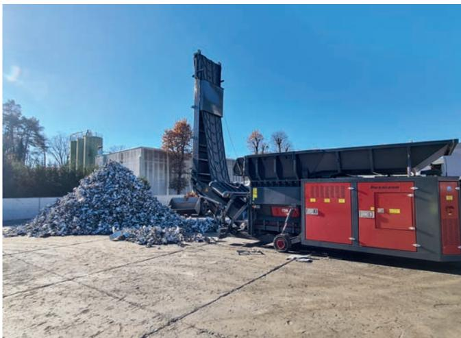
Der langsam laufende Zweiwellenbrecher HL UNI zeichnet sich durch ein intelligentes Hydrauliksystem mit einer Leistungsregelung und automatischer Drehzahlanpassung von 20–35 U/min aus. Die Antriebseinheit mit dem synchron laufenden Getriebe erreicht hohe Standzeiten. Das Antriebsmoment von 90000–130000 Nm an den Wellen, Niveauüberwachung, Temperaturüberwachung und Überlastsicherung sind weitere Qualitätsmerkmale der Brecheranlage!
