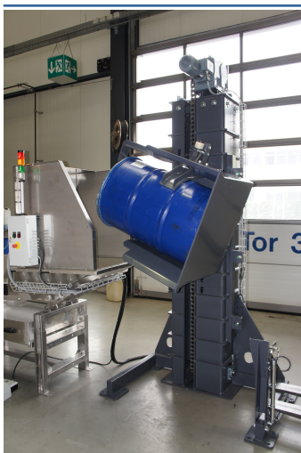
Hub-Kipplift beschickt das mit Ölfiter gefüllte Deckelfass in den Einfülltrichter Handsortiertisch
