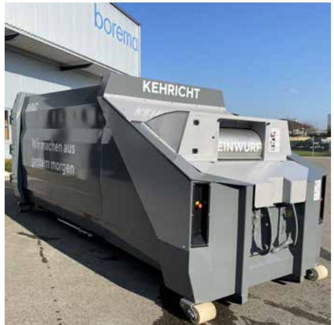
Presscontainer mit Einwurfschleuse für Kehricht
