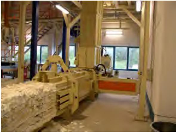
*Schneidkantenpresse gekoppelt an Späneabsaugung bei Swissprinters AG in Zofingen*
