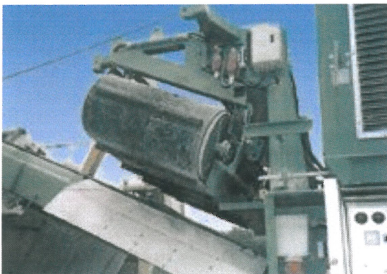
Magnetische FE-Teile werden mit dem Überbandmagneten aussortiert.
