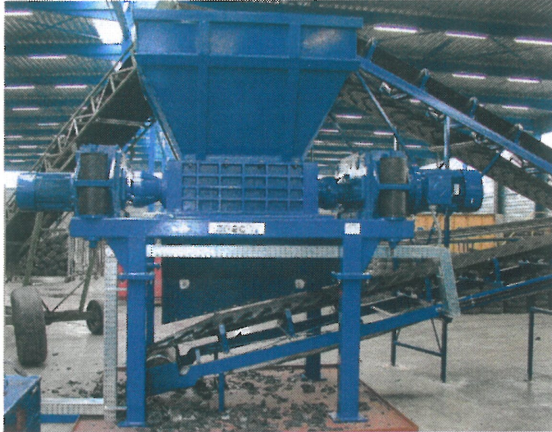
Abfälle werden durch den Zerkleinerer auf eine Korngrösse \approx 400 mm reduziert.
