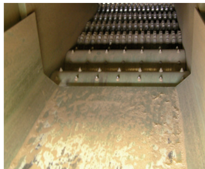
Trommelhacker VTH 75/30/7 mit Vorsiebzone zur Rindenabscheidung und Störstoffabscheidung
