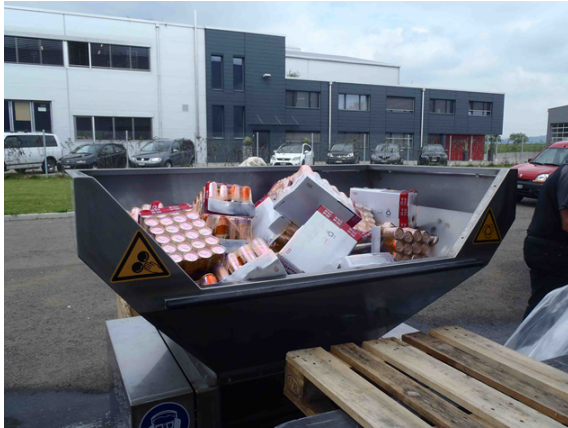
Aufgabe von Dosen mit Kartontray's und Folie in den grossen 600 l Trichter
