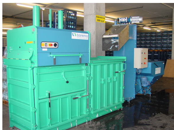
Der Perforator PF800 kann auch als Vorverdichter für Kleinballenpressen genutzt werden.
