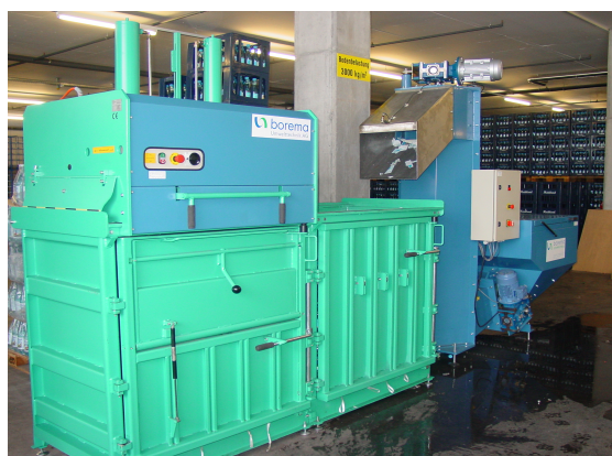
On peut utiliser le perforateur « PF 800 » aussi comme pré-compresseur pour des petites presses à balles.
