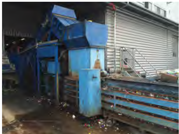
Aufgabeband, Perforator, Pressenschacht, Kanalballenpresse
