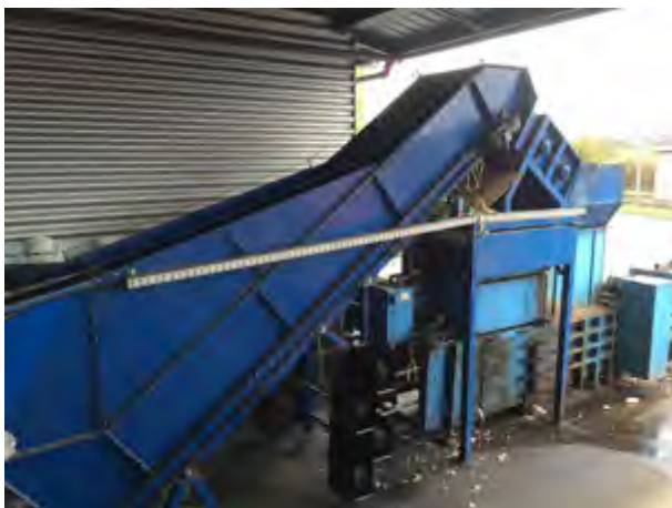
Ballenpressanlage mit Zufuhrband und PET-Perforator
