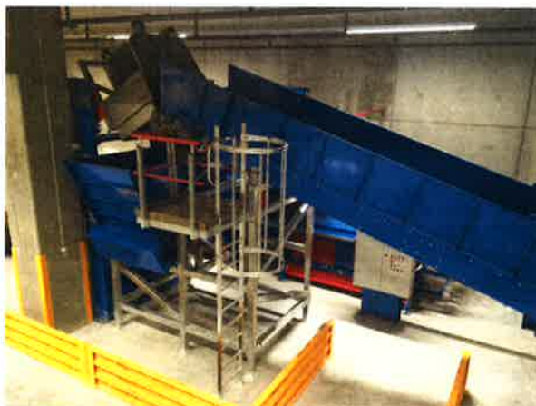
Pressenzufuhrband mit 17° Steigung für optimale Materialdosierung. Bandchassis gefertigt als Stahlblech- und Profilstahlkonstruktion.
