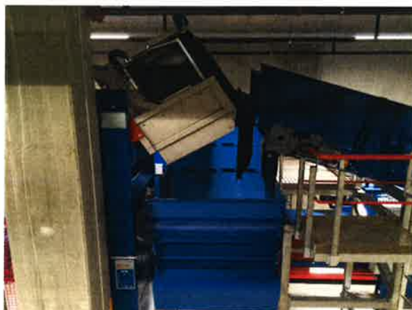
Robuste Hub-/Kippvorrichtung zur Entleerung von Normcontainern bis 500 kg.
