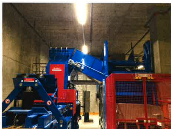
Kettengurtförderer als Zufuhrband zum Einfüllschacht der Ballenpresse.
