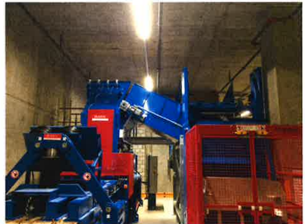
Schutzeinrichtungen in roter Signalfarbe erleichtern die Bedienung und erhöhen die Sicherheit.
