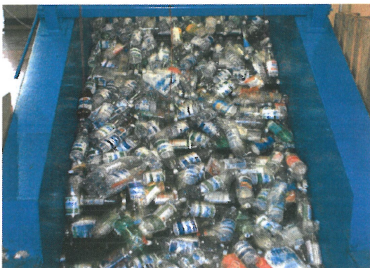
Lose PET-Flaschen auf dem Aufgabeband
