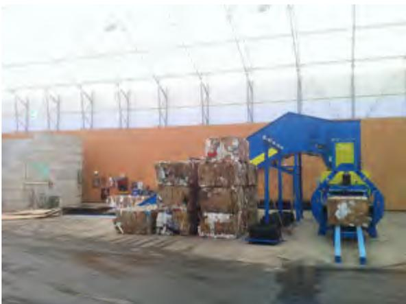
Pressenzufuhrband als Kettengurtt Förderer mit Schwannenhals am Bandende für eine optimale Materialübergabe in den Pressenschacht.
