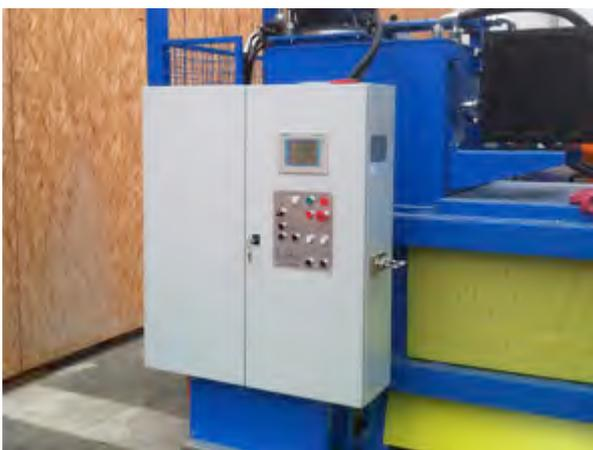
Standard SPS Steuerung SIEMENS PLC S7-313 C. 30 kW-Antrieb der Hauptpumpe für 74 Tonnen Presskraft.
