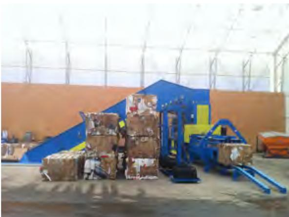
Grosszügige Stahlprofilkonstruktion für einen stressfreien Ballenauslauf, damit die Bindedrähte nicht überdehnt werden und keine Drahtbrüche resultieren.
