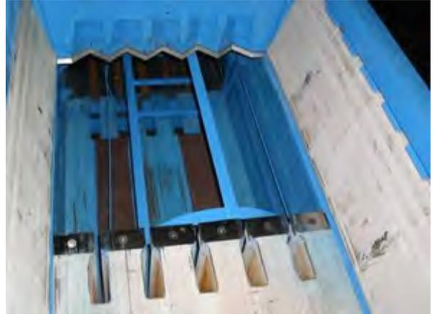
Presskammer der ANIS Ballenpresse mit Vorverdichtung dank seitlichen, hydraulischen Vorpressklappen.
