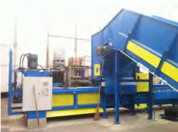
Um 200 mm erhöhte Maschinen-Füße für die Vertikal-Abbindung und für sehr gut zugängliche Reinigungsarbeiten unter der Ballenpresse.
