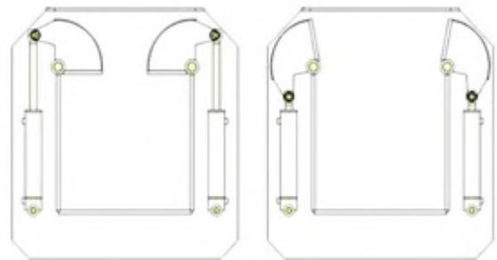
Funktionsweise der Vorpressklappen im geschlossenen bzw. offenen Zustand.
