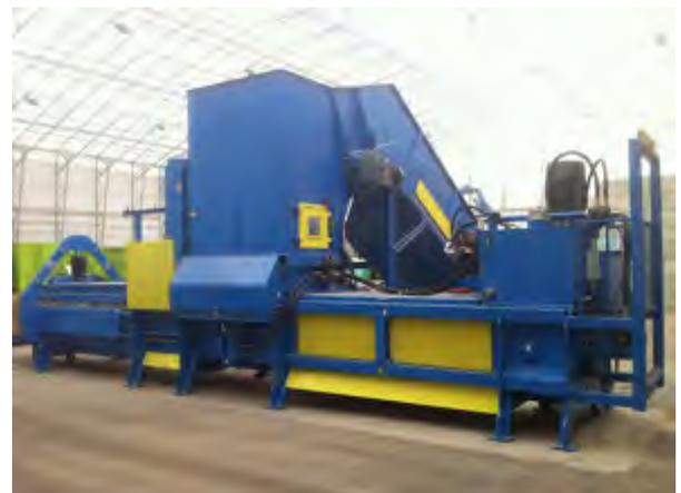
Seitliche, hydraulische Vorpressklappen für optimale Vorverdichtung, erhöhte Performance und Entlastung der Schneidmesser und somit geringeren Verschleiss.
