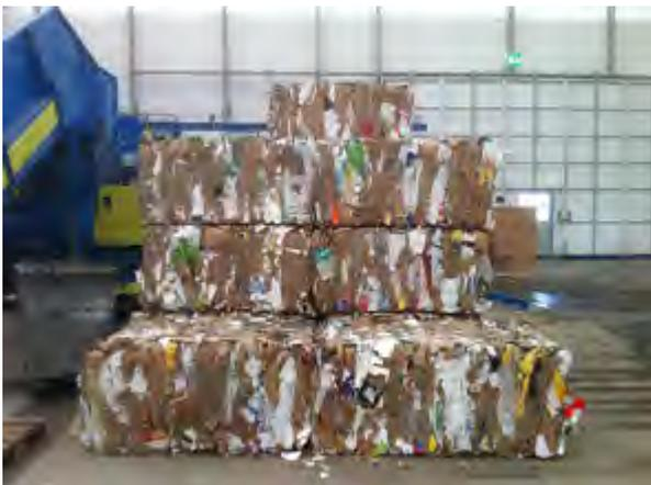
Ballendimensionen:  $b \times h = 1'100 \times 770$  mm, die Länge ist variabel einstellbar. Ballengewicht ca. 550 kg bei kartonagen mit einer Ballenlänge von 1'400 mm.
