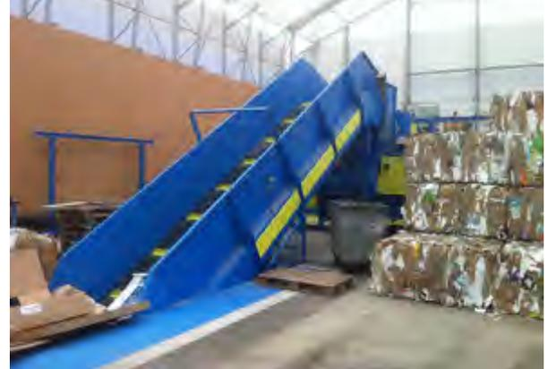
Pressenzufuhrband mit 30° Steigung für optimale Materialdosierung. Bandchassis gefertigt als Stahlblech- und Profilstahlkonstruktion.
