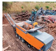
*Durch die Beschickung des mobilen Shredders mittels Greifbagger, bleibt immer Holz neben dem Trichter auf dem Motorenraum in 2.5 Meter Höhe liegen. Mitarbeitende nehmen dann, entgegen der Arbeitsanweisung, eine Beistelleiter und steigen auf das Dach des «laufenden Shredders» und werfen das liegen gebliebene Holz in den Trichter! Die Personen sind hochgradig an Leib und Leben gefährdet! Die Aufgabenstellung löste Borema wie folgt;*
