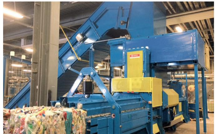
Durch den ein- und ausfahrbaren PET-Plätter können Sortenwechsel (z.B. von PET zu Karton) innert weniger als 2 Minuten ausgeführt werden. Der Borema PET-Plätter ist ein weitgehend verschleissfreies System um PET-Getränkeflaschen noch vor der Ballenpresse zu entlüften und flach zu drücken.
