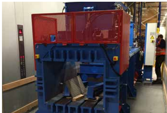
Ein 9 Tonnen schweres Teilstück der Ballenpresse im Warenlift
