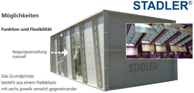
rotierenden Paddeln. Dieser komplette Paddelsatz ist manuell (beim STT5000 hydraulisch) neigungsverstellbar. Durch diese Verstellmöglichkeit (Neigungswinkel und Mitnehmeranordnung) kann der Ballistik-Separator an das aufgegebene Material angepasst werden. Das heißt, je größer der Neigungswinkel der Siebfläche, desto mehr Material befindet sich in der rollenden Fraktion und desto reiner ist die flächige Fraktion und umgekehrt.
