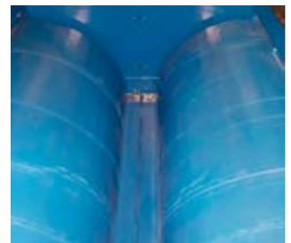
Die doppelten seitlichen Vorpressklappen in der Befüllöffnung der Presse schließen gleichzeitig, sodass ein geschlossener Presskanal zur optimalen Verarbeitung von homogenen, gut geformten und stapelbaren Ballen entsteht.
