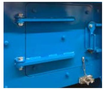
Wartungstür an der Presskammer
