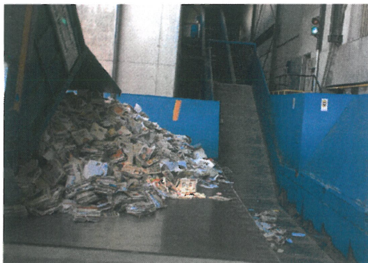
Materialaustrag auf den Pendelplattenförderer
