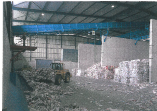
Austragsförderer zur Pulper- / Papiermaschine, 60 t/h
