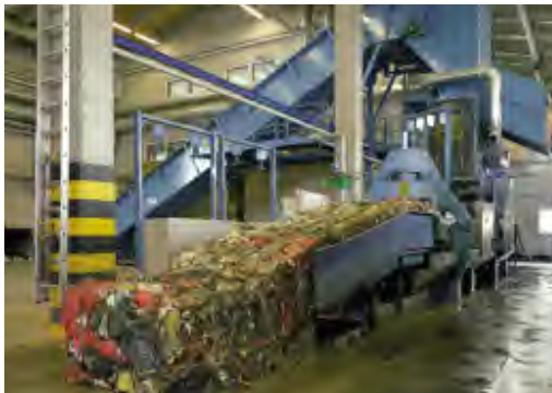
Ballenpresse Typ BOA D130 mit Spezialoptionen wie Nutzenabschieber, Restabfall-abfuhrsystem,
