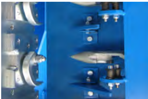
...und Durchstichnadeln mit Keramik-Verschleisseinsätzen.
