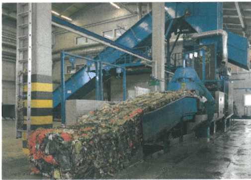
Ballenpresse Typ BOA D130 mit Spezialoptionen wie Nutenabschieber, Restabfallabfuhrsystem,
