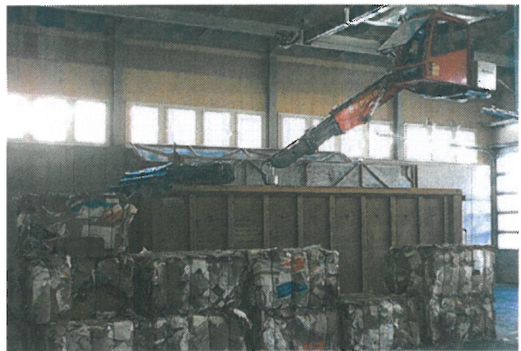
... hydraulischen Hallenkran in die Bahncontainer verladen.
