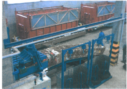
Die fertig gepressten Ballen mit einem Gewicht von bis zu 1'600 kg pro Stück werden mit dem ....
