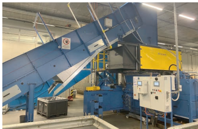
COOP, Zufuhrband mit berührungslosem Personenschutzsystem und PET-Plätter zu Ballenpresse
