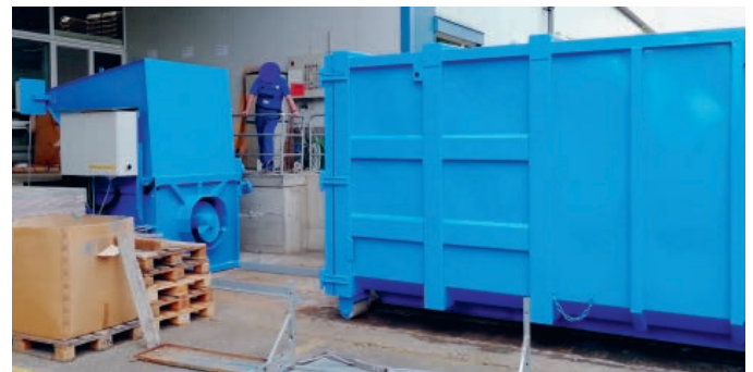
Stationärer Presscontainer H & G SV 15 S
