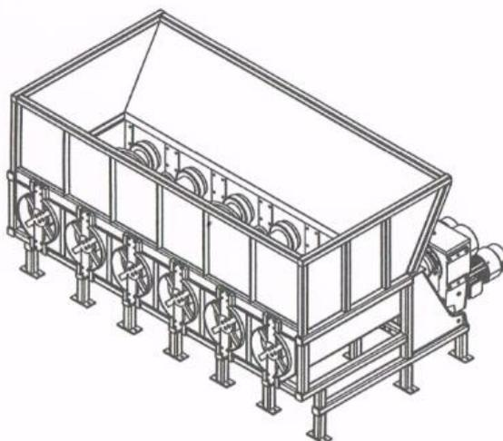
Der Rahmen ist aus Profile (RHS), und die Bodenplatte ist aus Stahl oder Hardox gemacht.
