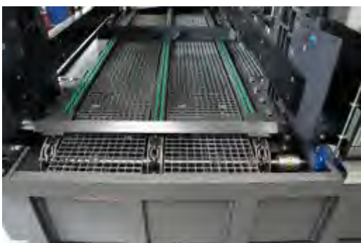
Bac de rétention d'huile avec segments de grille accessibles, incl. surveillance de niveau
