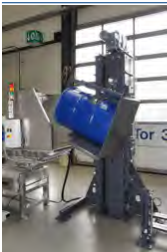
La benne basculante alimente le fût plein dans la trémie de la table de tri manuelle
