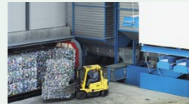
PET-Bunker ( 4 x 180m 3 ) mit vollautomatischer Materialaustragung
