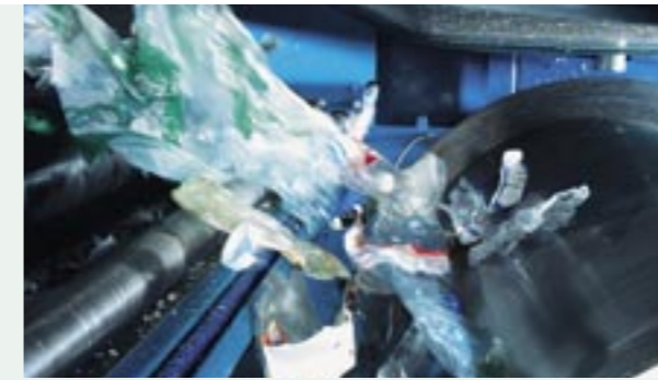
Abscheidung von losen Etiketten, Folien und Grossteilen mit dem Borema Labelabscheider
