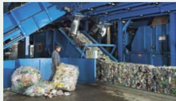
Aufgabebereich: Beschickung der Anlage, Ballen in den 4-Wellen-Ballenbrecher, Lose- und Containerware in den Borema PET-Plätter
