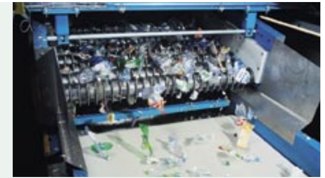
Abscheidung von Kleinteilen aus dem PET-Flaschenstrom mit dem Borema Scheibensieb
