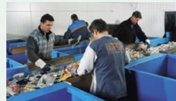
Manuelle Inspektion/Nachsortierung des vorsortierten PET-Materialstroms auf eine Reinheit von ≥ 99.99%
